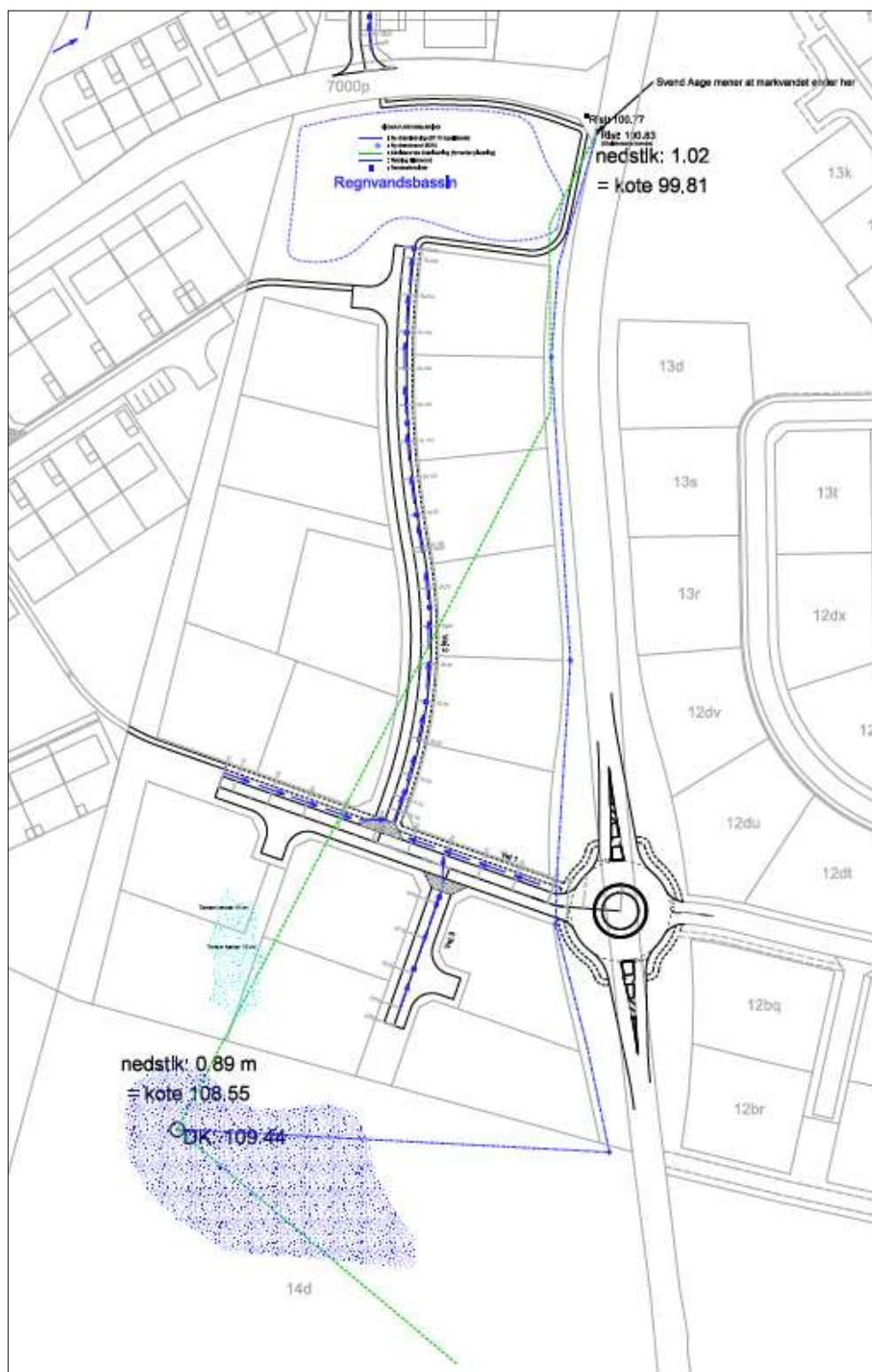
Figur 5. Drænkort der viser eksisterende drænledning (grøn linje) og fremtidige drænlednings trace (blå linje langs Svinsagervej)
